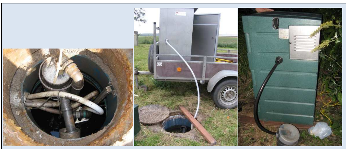
Figuur 2.1 Monstername effluent uit een monsterputje in de nabezinktank van een compactstelsysteem (links), uit de nabezinktank van een compactstelsysteem (midden) en het inspectieputje van een helofytenfilter (rechts).
